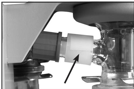
**Überdruckventil** am Emissionskondensator.....
