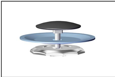
Neue Membrane zwischen Membranspannscheibe und Membranstützscheibe einlegen.
