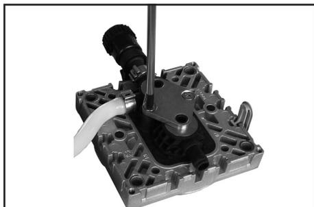
Spannpratzen auf den Ventilinseln lösen.
